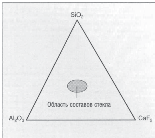
Рис. 2.3.2. Состав стекла, используемого в стеклоиономерных цементах
