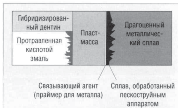
Рис. 3.6.14. Схема соединения металл-пластмасса
