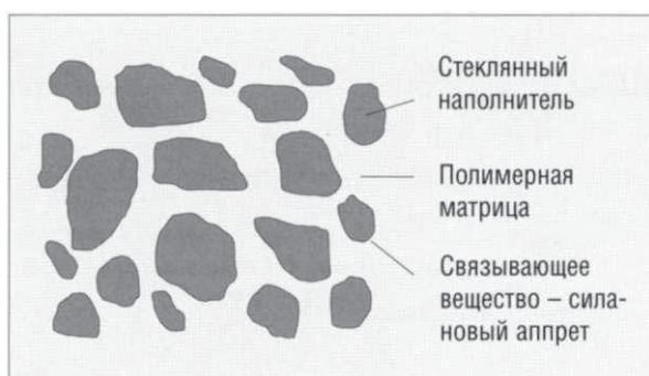
Рис. 2.2.1. Структура композитных восстановительных материалов
