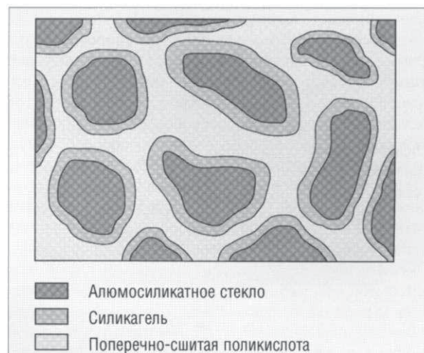
Рис. 2.3.9. Структура стеклоиономерного цемента
