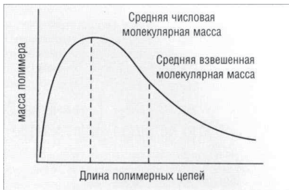
Рис. 1.6.5. Пример типичной кривой молекулярно-массового распределения полимера
