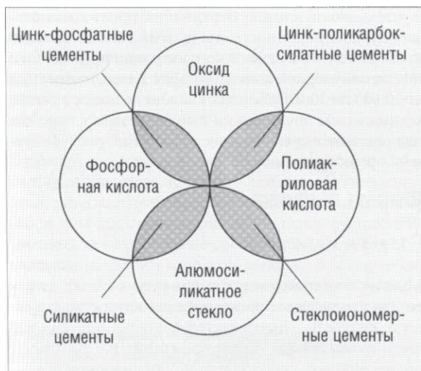
Рис. 2.3.1. Схематическое представление взаимоотношений между различными стоматологическими цементами на основе порошков оксида цинка и алюмосиликатного стекла, а также жидкостей, состоящих из фосфорной и полиакриловой кислот
