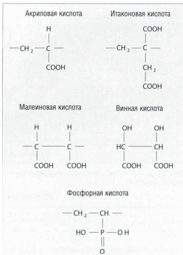
Рис. 2.3.3. Кислоты, используемые в составах стеклоиономерных цементах
