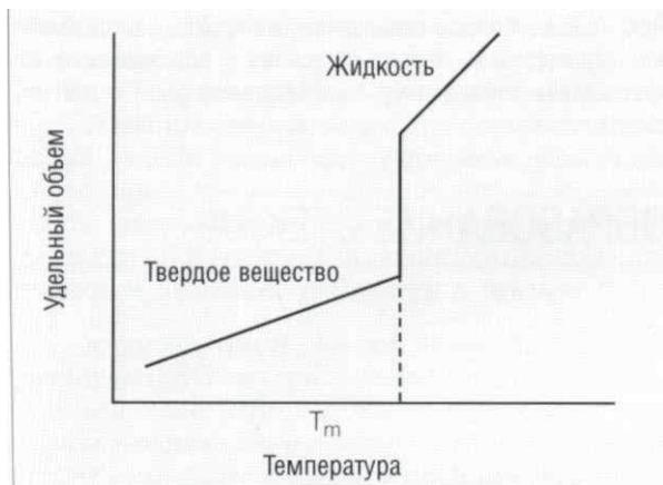
Рис. 1.4.2. График перехода от твердого состояния к жидкому, где T_m - температура плавления
