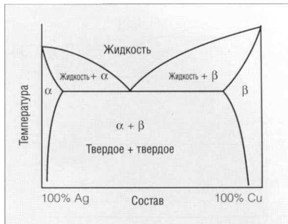
Рис. 1.5.12. Фазовая диаграмма равновесия для системы Ag-Cu
