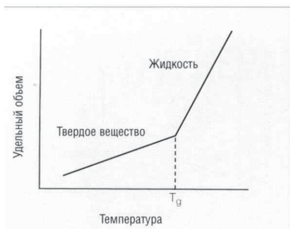
Рис. 1.4.4. Удельный объем при изменении температуры аморфного материала в твердом состоянии
