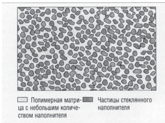
Рис. 2.2.23. Композит с наполнителем из небольших по размеру частиц
