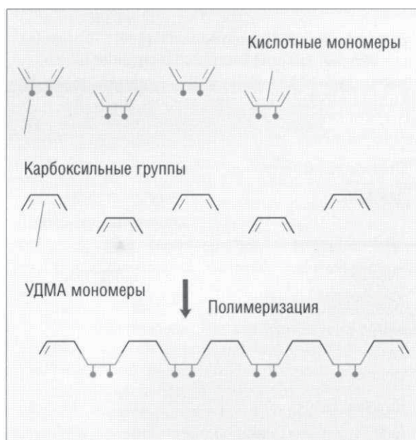
Рис. 2.2.26. Сополимеризация кислотного мономера, содержащего карбоксильные группы, и УДМА мономера в компомере
