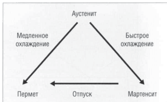
Рис. 3.7.5. Горячая обработка, известная под названием отпуск, для мартенситной стали для контроля ее механических свойств
