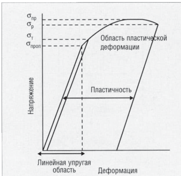
Рис. 1.7.3. Кривая напряжение-деформация для пластичного (ковкого) металла ( \sigma — предел прочности при растяжении; \sigma_r — прочность при разрушении; \sigma_t — предел текучести; \sigma_{проп} — предел пропорциональности)
