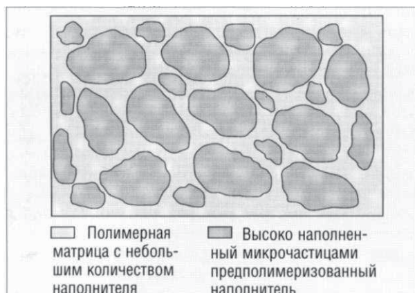
Рис. 2.2.21. Гетерогенная структура микронаполненного полимерного композита с использованием предполимеризованных частиц, которые добавлены к полимеру, содержащему небольшое количество коллоидного оксида кремния
