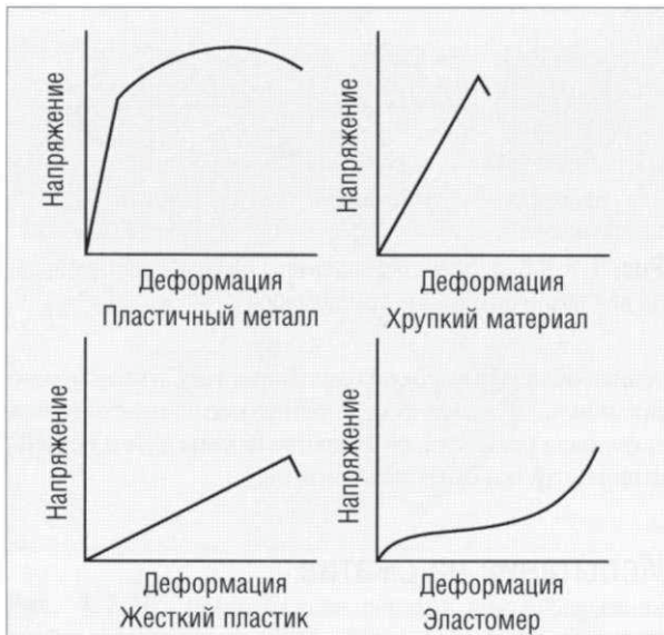
Рис. 1.7.5. Вид кривых напряжение-деформация для материалов различного типа. Кривые представлены не в масштабе
