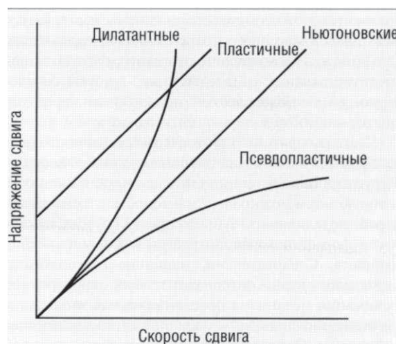
Рис. 1.8.3. Графическое представление реологических свойств ряда жидкостей
