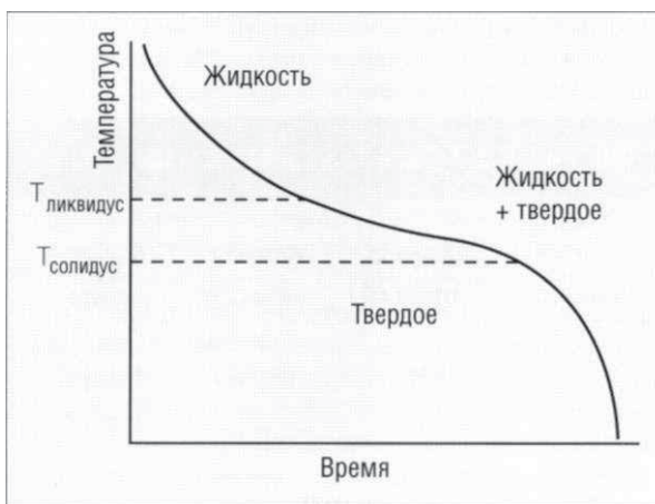
Рис. 1.5.10. Кривая охлаждения сплава
