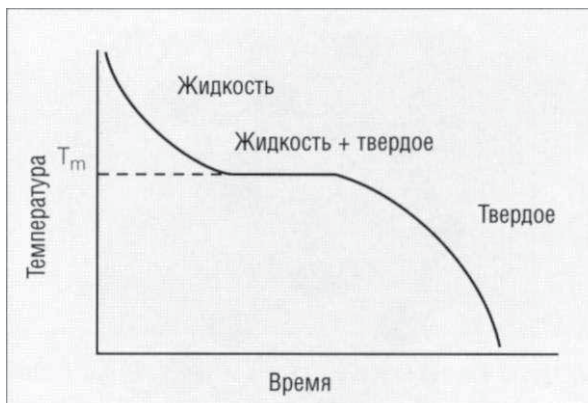
Рис. 1.5.9. Кривая охлаждения расплава чистого металла
