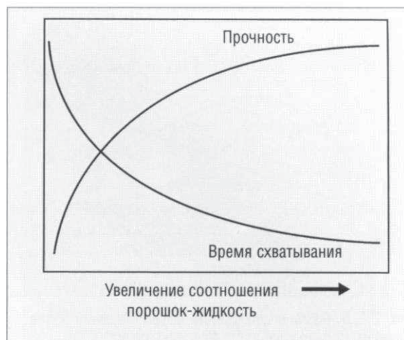
Рис. 2.3.4. Влияние изменений соотношения порошок-жидкость на свойства стеклоиономерных цемента
