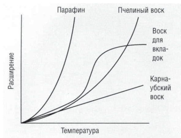
Рис. 2.7.2. Термическое расширение восков
