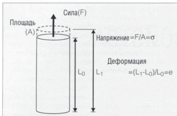
Рис. 1.7.1. Образец материала в виде стержня растягивается в направлении продольной оси
