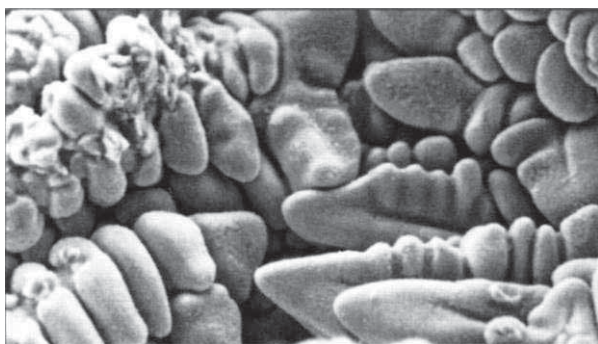
Рисунок 1.5.14 Микрофотография под сканирующим электронным микроскопом дендритной структуры сплава Co-Cr
