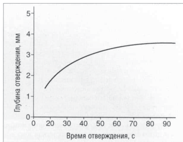
Рис. 2.2.12. Глубина отверждения как функция времени отверждения
