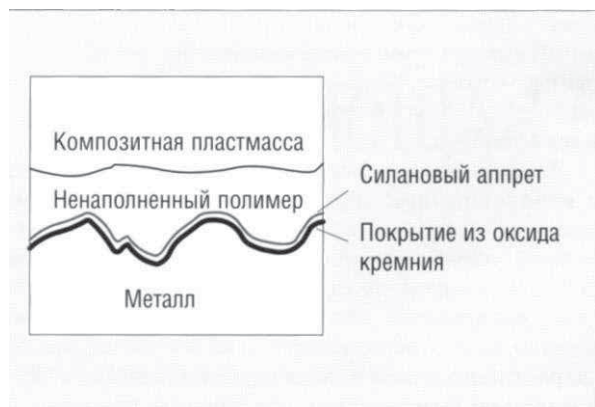
Рис. 3.6.12. Поверхность металла с покрытием из оксида кремния
