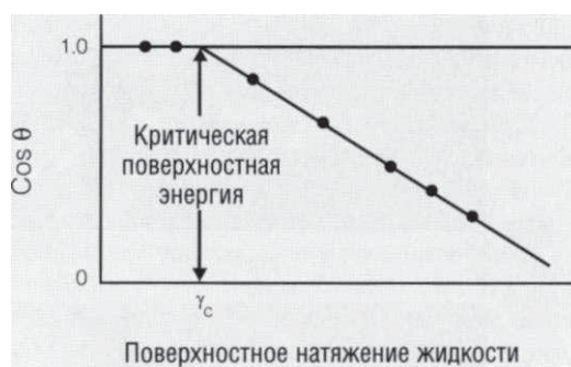
Рис. 1.10.5. График Зисмана для определения величины критической поверхностной энергии твердого тела
