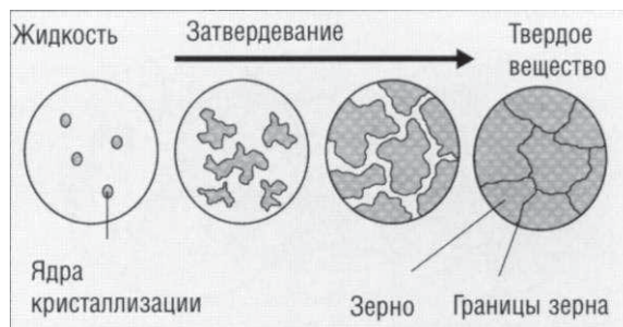
Рис. 1.5.1. Процесс твердения металла
