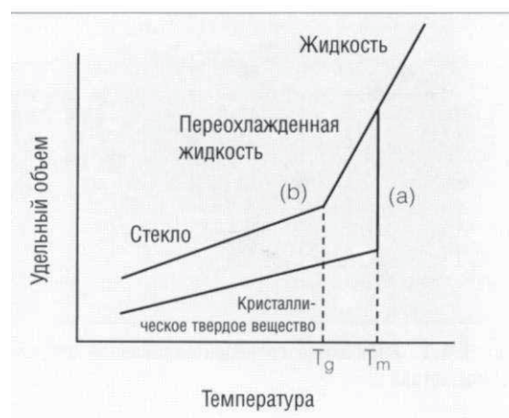
Рис. 1.4.5. Кривые охлаждения материала, который может переходить в твердое состояние с образованием (а) кристаллической структуры или (б) аморфной структуры стекла
