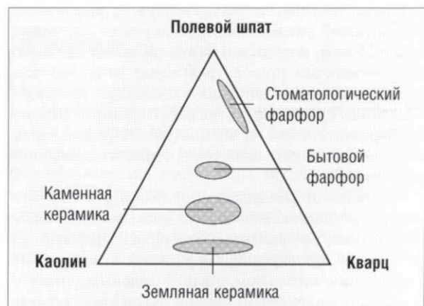
Рис. 3.4.2. Относительные составы керамических изделий, изготовленных на основе полевого шпата, каолина и кварца
